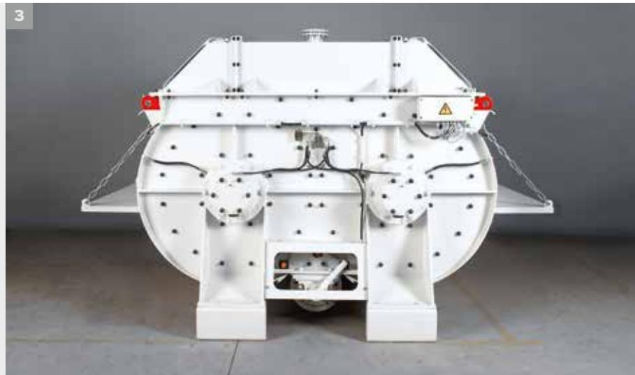
**3** | El accionamiento de los ejes de mezclado se realiza a través de dos engranajes abridados que están accionados por uno ó dos motores mediante una correa trapezoidal. Los ejes de mezclado se apoyan en unos rodamientos y están obturados en ambos extremos en las partes frontales. No requieren mantenimiento gracias a la lubricación central.
