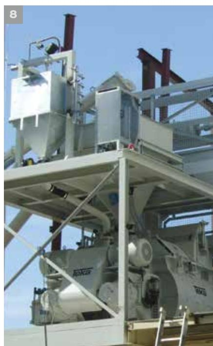
**8** | D'après la conception des centrales à béton, l'alimentation des malaxeurs s'effectue par l'intermédiaire d'un skip de chargement par le fond soit par skip à retournement.
