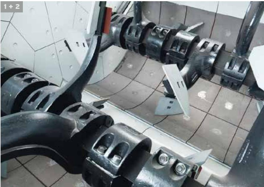
**1** | La cuve en exécution standard est revêtue de carreaux de fonte de haute qualité. Les côtés sont équipés de revêtement d'usure démontable.
