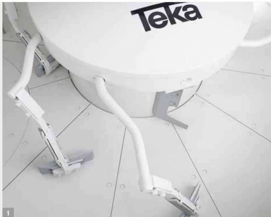
**2** | En option il existe un système de graissage centralisé des douilles. Les palettes de malaxage, les manchettes de protection des bras, les racleurs de paroi extérieure sont
