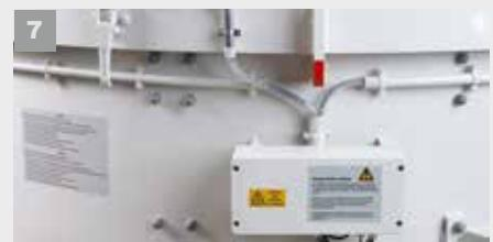
de estrella) para todos los puntos de lubricación, lubricación a través de una bomba central accionada por un motor eléctrico.
